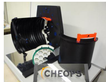
Prototipo 3D del telescopio relativo alla missione CHEOPS. (Image Courtesy INAF)
