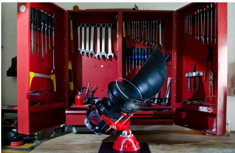
Uno dei 26 obiettivi installati sul satellite che scruterà i pianeti extra-solari durante la missione PLATO. (Image Courtesy INAF)
