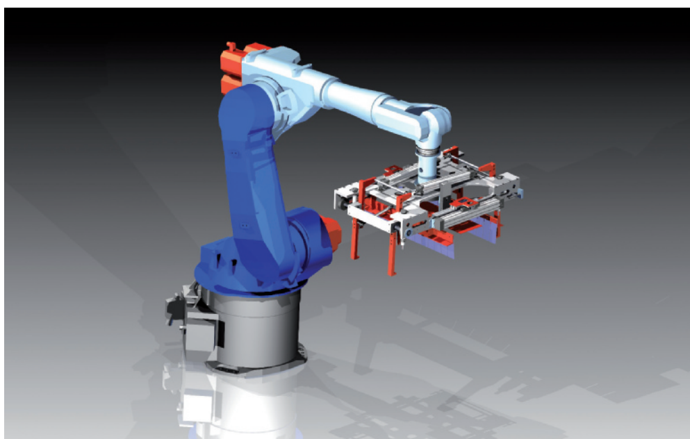
Manipolatore pallettizzazione scatole bottiglie. Simulazione cinematica.
