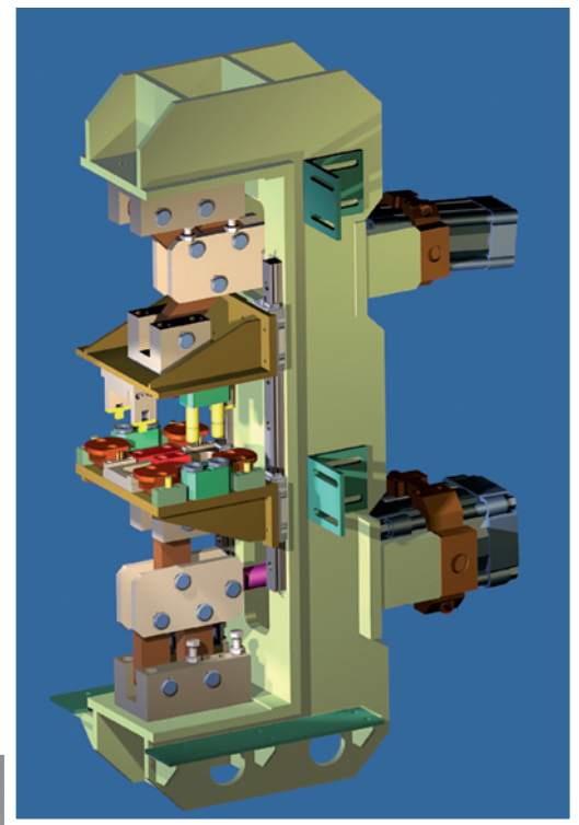
Unità di punzonatura multipla per elementi cambio automatico. Settore Automotive.
